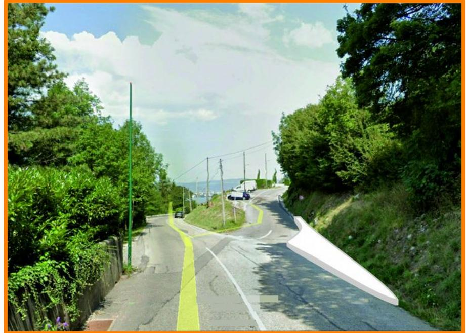
☞ *La dénivellation et l'emprise exigüe compliquent une modification importante de ce carrefour. Une reprise du profil en long de l'extrémité de la route de la Corniche serait pour cela nécessaire.*
